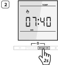
Der voreingestellte Bildschirmschoner ist die Bodentemperatur. Drücken und halten Sie die **MODE/OK** Taste für 2 Sek. Die Anzeige wechselt zur aktuellen Uhrzeit.
