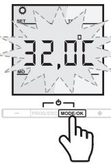
Bestätigen Sie auch diese Eingabe mit der **MODE/OK** Taste. Das Display zeigt nach Abschluss der Einstellungen die aktuelle Temperatur an.
