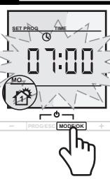
Drücken Sie die **MODE/OK** Taste. Die Uhrzeit beginnt zu blinken.Press the **MODE/OK** button. The clock time will start to blink.Appuyez sur le bouton **MODE/OK**. L'heure commence à clignoter.
