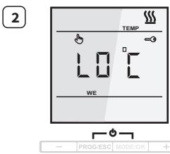
**LO °C** Anzeige für den Fall, dass die Heizung nicht in der Lage ist, den Boden um mehr als +5°C zu erwärmen
