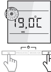
Wählen Sie den Programmbetrieb mit Hilfe der „–“ Taste.
