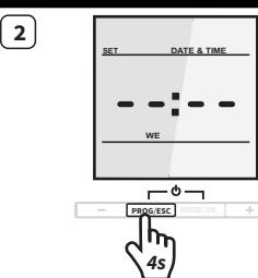
Drücken und halten Sie die **PROG/ESC** Taste für 4 Sek.Press and hold **PROG/ESC** button for 4 seconds.Appuyez sur la touche **PROG/ESC** pendant 4 secondes.
