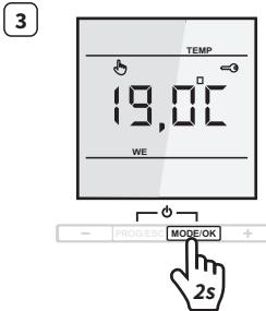
Wenn Sie die **MODE/OK** Taste erneut für 2 Sek. drücken, wechselt die Anzeige wieder zur Bodentemperatur.
