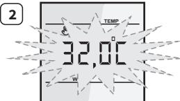
Die Bodentemperatur mit Hilfe der „+“ oder „-“ Taste einstellen.
